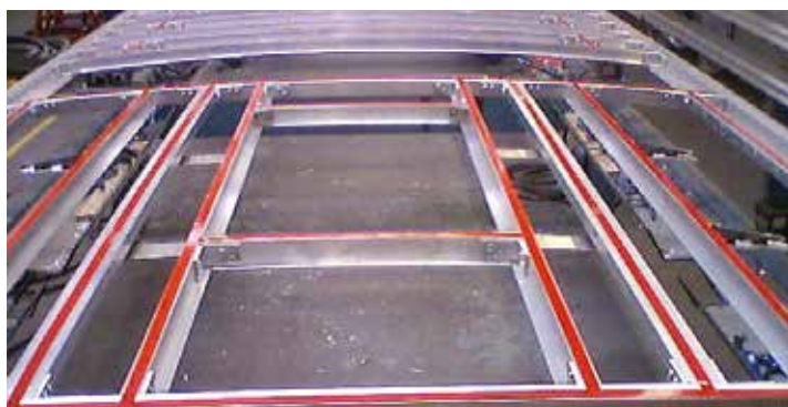
Reforac UPPER BOND 5110W utilizado para la fabricación de techos de autobuses por uno de los principales fabricantes de Europa.
