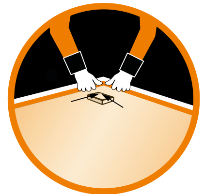
Ilustración 10. Acabado de las esquinas con presión hacia el empalme de ambos lados.
