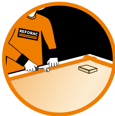
Ilustración 6. Una presión firme con la mano sobre el rodillo facilita una unión fuerte.
