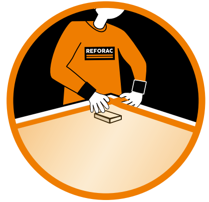
Figuur 7. Overlapping van tape bij de hoek.
