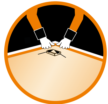
Figuur 10. Afwerken, met druk, van de hoek naar de verbinding vanaf beide kanten.
