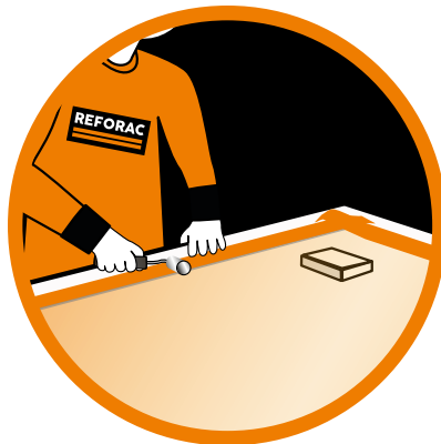
Figuur 5. Stevig aandrukken met de roller vergemakkelijkt een sterke hechting.
